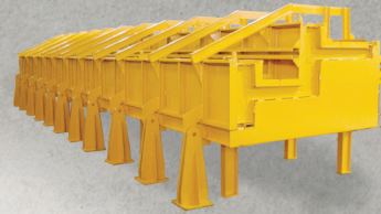
Fôrma de Arquibancada (Basculante)
