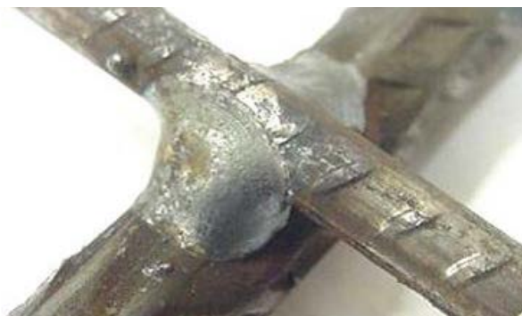
▲ Má distribuição - Considera-se sobreposição de solda e soldagem nas duas faces das juntas.
