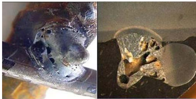
▲ Porosidade - Não influencia a integridade física do metal base, mas a solda fica frágil.
