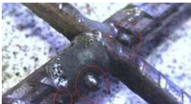
▲ Respingo - Evidencia trabalho com amperagem alta, não adequada. Potencializa mordedura.
