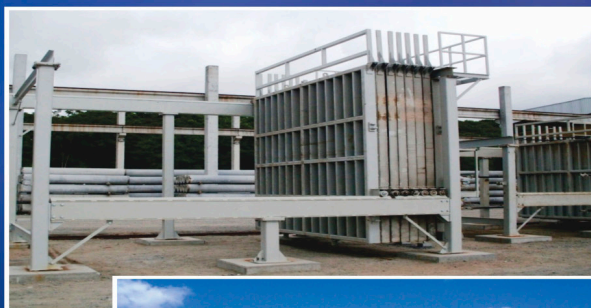
Fôrmas Tipo Bateria para Paredes
