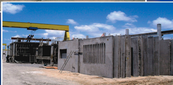
Fôrmas Tipo Bateria para Paredes
