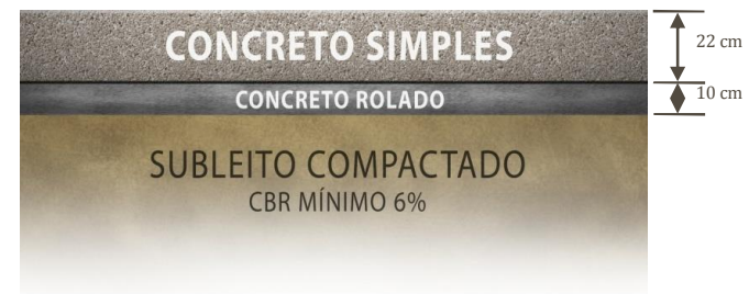
Pavimento de Concreto
