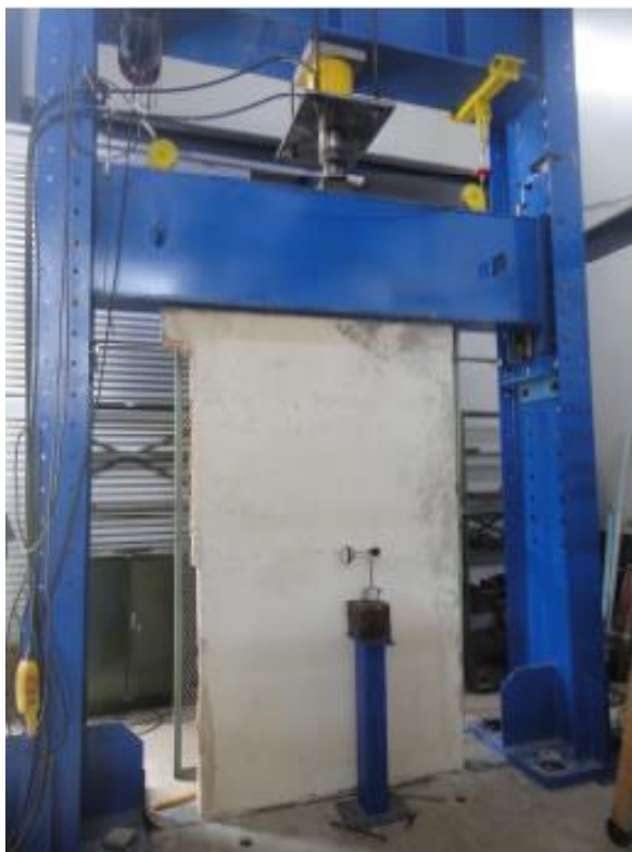
Ensaio de compressão excêntrica
