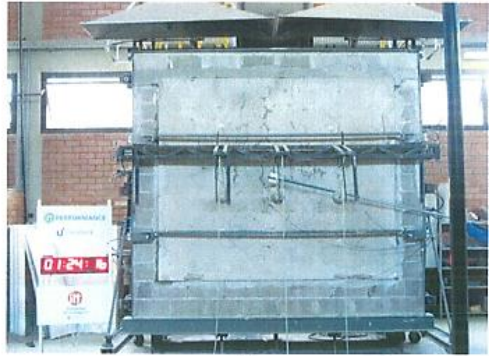
Corpo de prova em processo de ensaio – programa de aquecimento de 120 min
