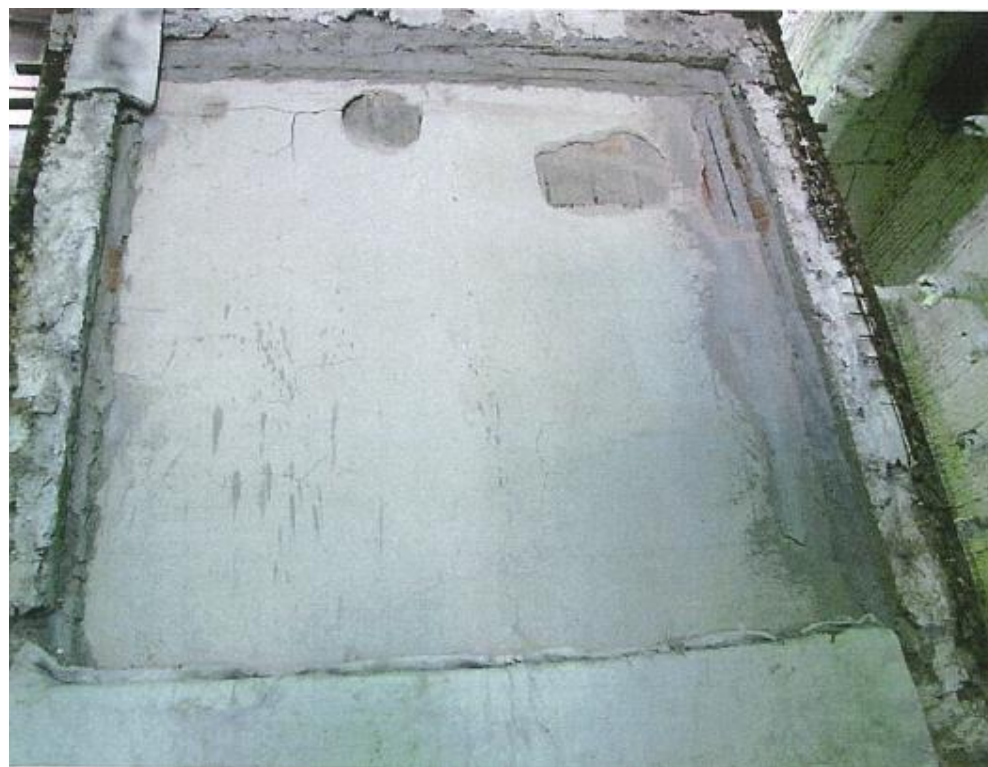
Face exposta ao fogo (após programa de aquecimento)
