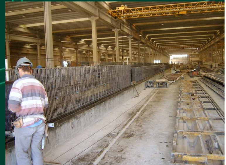
Armadura Frouxa. Armadura Protendida.
