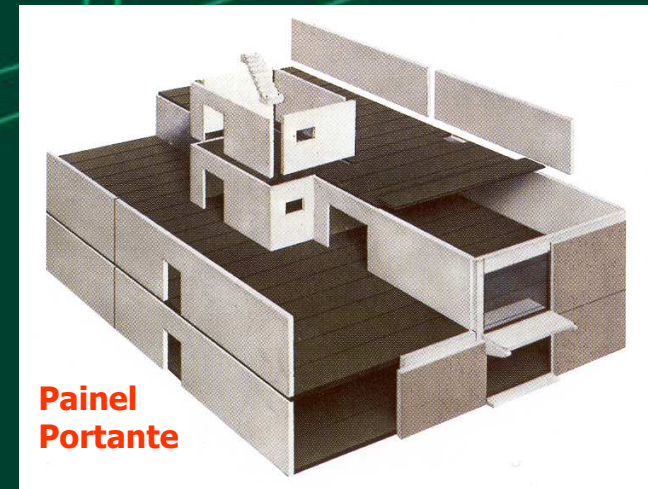
Estrutura tipo PAINÉIS PORTANTES
