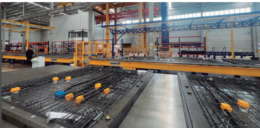
Fábrica, equipada com sistema carrossel e tecnologia da Vollert, pode produzir, em seis meses, até 20 prédios com 120 apartamentos
