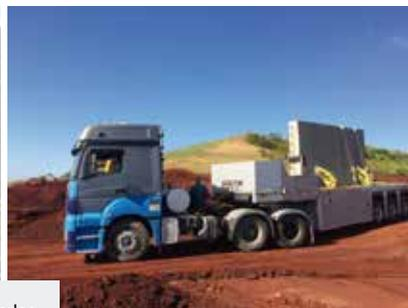
Uso de carretas in loader para transporte de peças pré-fabricadas
