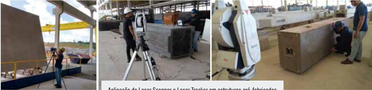
Aplicação de Laser Scanner e Laser Tracker em estruturas pré-fabricadas
