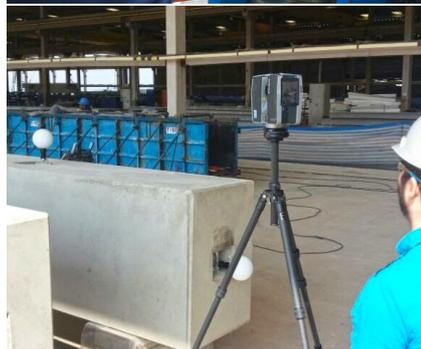
Identificação e Rastreabilidade do processo, controle tecnológico com laboratórios próprios, escaneamento de peças visando atingir alta precisão e desvio zero no controle dimensional, são práticas correntes nas indústrias que integram o programa
