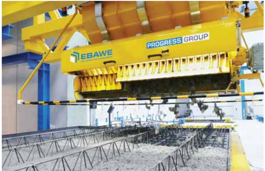
A indústria de equipamentos se atualiza de forma permanente na automação e soluções com emprego de alta tecnologia para as plantas de concreto pré-fabricado
