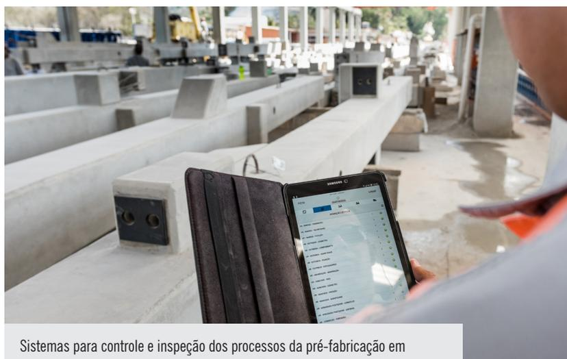
Sistemas para controle e inspeção dos processos da pré-fabricação em concreto por meio de celulares ou tablets estão em desenvolvimento
