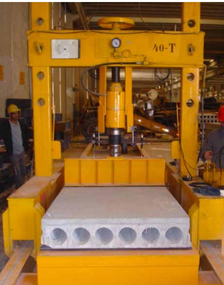
■ Ensaio de cisalhamento de lajes alveolares protendidas pré-fabricadas em instalações de fábrica com parceria do NE-TPRE/UFSCAR.
