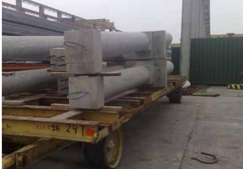
■ Pilares circulares de alta resistência e lajes alveolares em fábrica na Bélgica sendo transportados internamente na planta de produção
