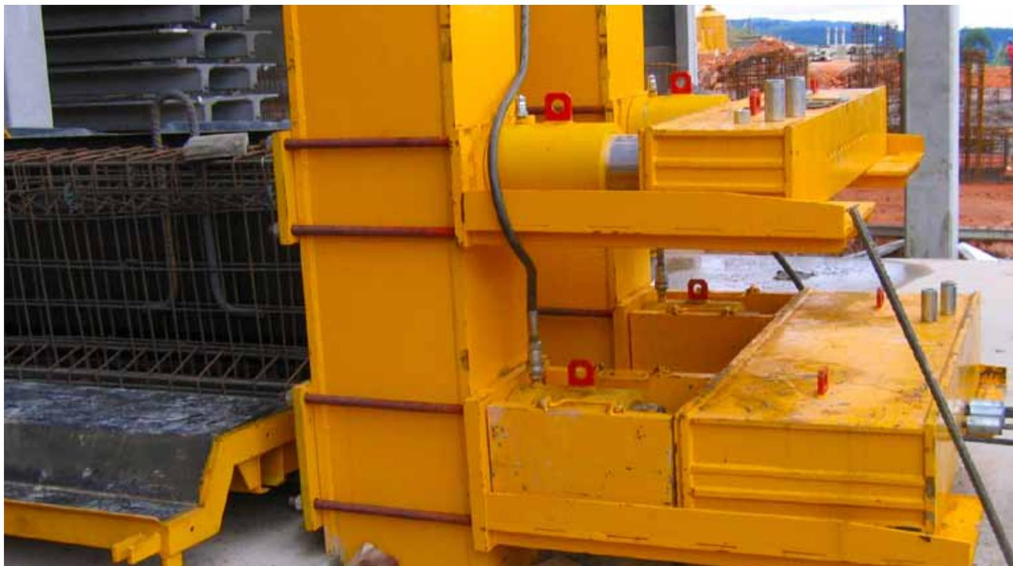
■ Cabeceira de protensão de pista de vigas protendidas grandes, de alta capacidade de carga
